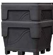
**Emboîtables:** Murs obliques permettant d'emboîter les caisses-palettes les unes dans les autres. Économisent de l'espace en entrepôt et réduisent les coûts de transport à vide. Ces caisses nécessitent obligatoirement un couvercle pour être empilées. L'empilement est restreint à 2 unités de haut maximum, car c'est le couvercle qui supporte la charge et non les coins de la caisse. Offertes avec des murs pleins seulement et un drain est disponible sur demande.
